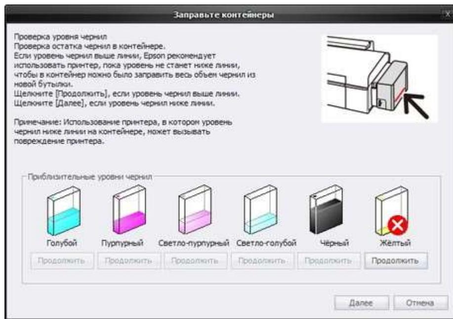
Не допускайте полного опустошения емкости-донора! Система с пустым донором при продолжении печати затянет воздух в канал подачи чернил, и от него будет сложно избавиться – придется потом или подтягивать чернила шприцом, вставленным в выходное отверстие демпфера,
