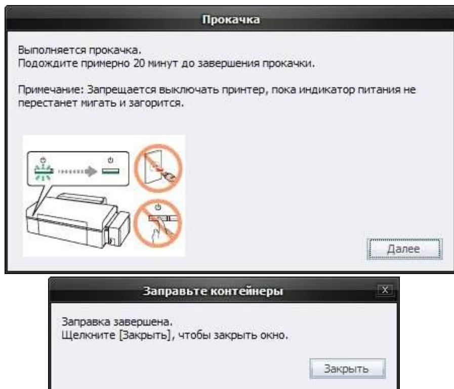
Главное - при этом помнить, что при этом транспортировочный фиксатор, расположенный на торце емкостей СНПЧ должен быть разблокирован, в противном случае чернила не будут подаваться и емкости СНПЧ не заполнятся при первичной заправке или появятся дефекты печати, если в таком состоянии система дозаправлялась:
